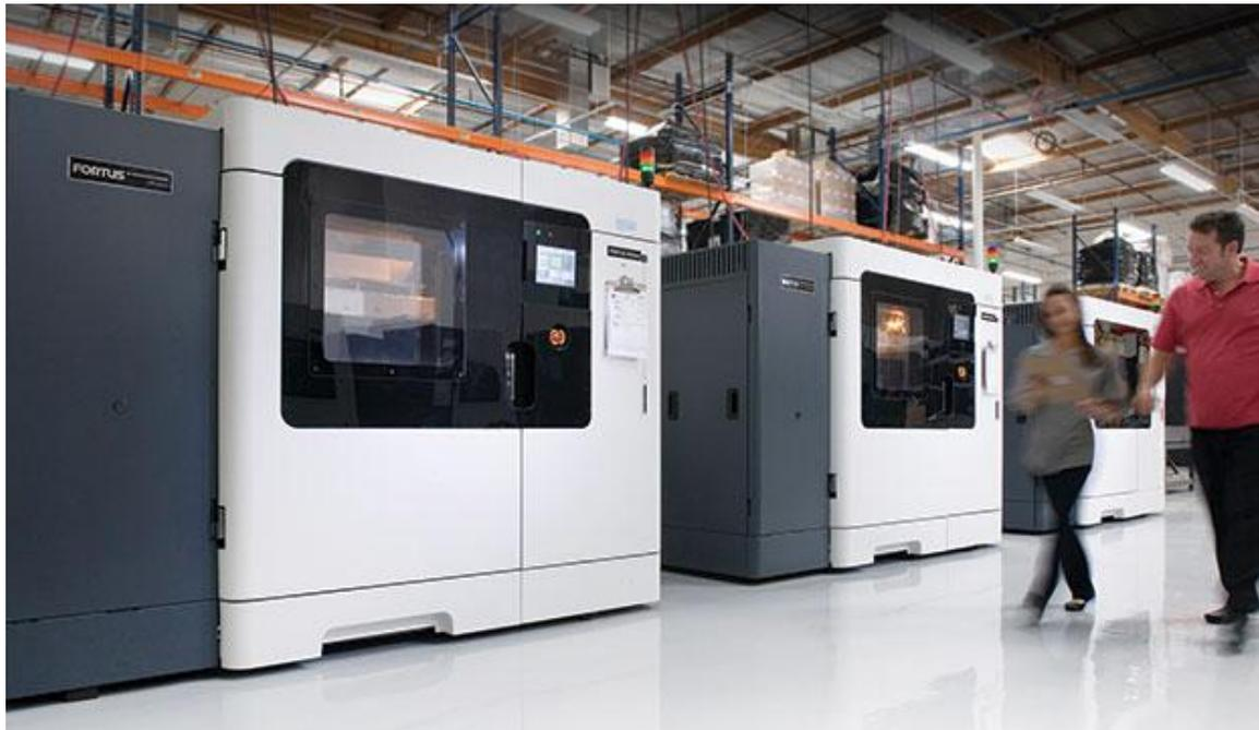
而正是看中了 3D 打印的无限制造可能，XEV 电动车公司从诞生之初，就致力于把 3D 打印技术运用在量产汽车上，由于 3D 技术生产属于增材制造，不再使用模夹具，3D 打印汽车的部件总数相比传统汽车会减少 90%。
