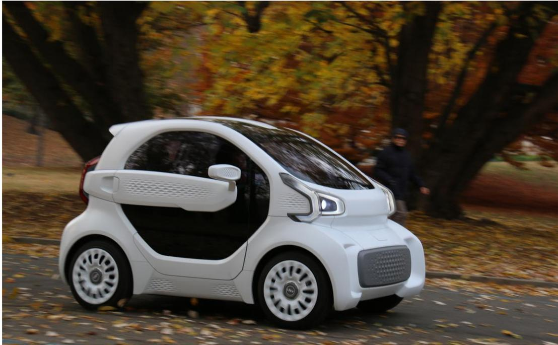
XEV 电动车公司第一款产品定位为城市多用途小型双座智能汽车,全部饰件为 3D 打印的非结构件,制造材料使用从玉米中提炼出的环保材料,成本低廉。3D 打印制造技术拥有无与伦比的灵活性,极为适合车辆不同设计风格与功能的个性化定制。
